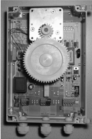
Корпус управления клапаном монтируется на 6-ходовой клапан с **заранее установленным адаптером**. Далее укрепить корпус с большой шестерёнкой посредством стержня, проворачивая вправо на адаптере. Шестерню следует при этом прикручивать до тех пор, пока корпус полностью "ляжет" на 6-позиционный клапан.
